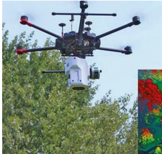
شکل ۲۲-۴ طیف‌سنج فراطیفی VNIR/SWIR با آشکارسازی و اندازه‌گیری (LIDAR) یکپارچه برای تعیین کمیت موم برگ و سایر ویژگی‌های منحصربه‌فرد سازگار با تنش گرما
