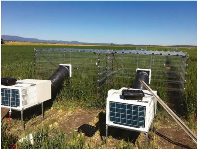
شکل ۱۰-۲ محفظه‌های حرارتی مجهز به واحدهای تهویه مطبوع مستقر در مزرعه، نارابری، نیوسالتولز، استرالیا.
